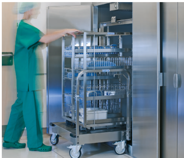
Transfert au moyen d'une armoire à double accès
